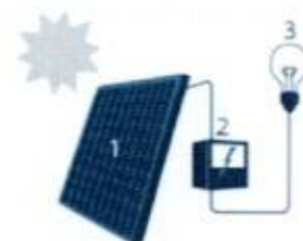
1. Zonnepaneel | 2. Omvormer | 3. Elektrische toestelen
