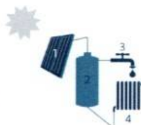
1. Zonnecollector | 2. Opslagvat zonneboiler | 3. Sanitair warm water | 4. Afgifteenheid voor ruimteverwarming (optioneel)
